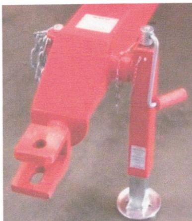
Foto 5: dispositivo de apoio e engate
